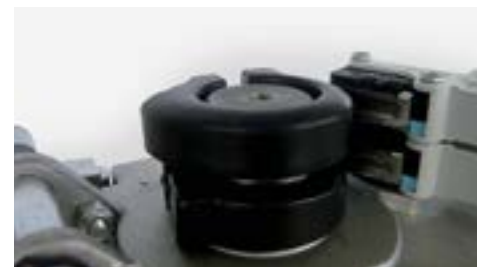
Finecorsa con regolazione di precisione
