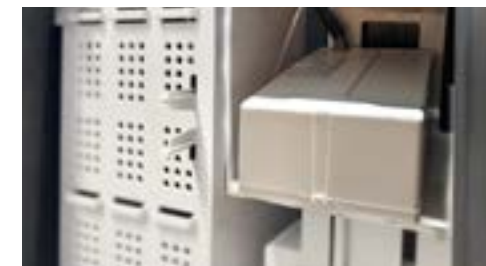
Batterie tampone da 2Ah (opzionali)
