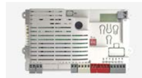
Nuova centrale CTE20324 con ricevente integrata programmabile con KUBEPROW
