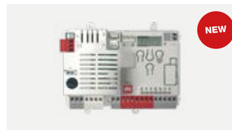
Nuova centrale CT103 con ricevente integrata programmabile con KUBEPROW
