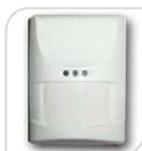
Sensore doppia tecnologia per interno PIR + Microonda - Antimascheramento - Memoria allarme - Esclusione LED - Relè di uscita - Lente "Fresnel" a 18 fasci - Portata 12x12m - Installazione a muro - Regolazione 90° in orizzontale 30° in verticale - Snodo in dotazione
