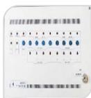
Centrale 8 zone – Ingressi linee NC verso il negativo – Un ingresso linea N.C. temporizzato Protezione antisabotaggio – Inserimento con chiave meccanica - Possibilità di inserimento con chiave elettronica esterna - Uscita 12V per sirene piezoelettriche – Uscita 12V per sirene autoalimentate – Uscita relè contatto puro per connessione avvisatori esterni, Alimentazione 220V e carica batteria da 3°
