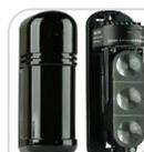
Barriera all'infrarosso a triplo raggio – Portata 200m – Potenti lenti Fresnel ad alta concentrazione di raggio - 8 frequenze selezionabili – Regolazione lenti 180° in orizzontale, 20 in verticale – Anti abbagliamento – Anti interferenza – Resistente al falso allarme dato dall'acqua, dalla polvere e degli insetti – 10 LED per la calibrazione – Tempo di risposta da 50 a 700 ms – Tempo d'allarme 2s – Uscita d'allarme NO e NA – 11/18V
