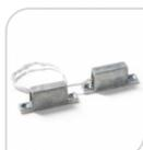
Contatto magnetico rettangolare in zama - Grado di protezione IP65 - montaggio a vista - 4 fili (2 del contatto, 2 del tamper) - 25cm di lunghezza cavo - Confezione da 10PZ
