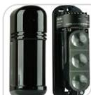
Barriera all'infrarosso a triplo raggio – Portata 100m – Potenti lenti Fresnel ad alta concentrazione di raggio - 8 frequenze selezionabili – Regolazione lenti 180° in orizzontale, 20 in verticale – Anti abbagliamento – Anti interferenza – Resistente al falso allarme dato dall'acqua, dalla polvere e degli insetti – 10 LED per la calibrazione – Tempo di risposta da 50 a 700 ms – Tempo d'allarme 2s – Uscita d'allarme NO e NA – 11/18V
