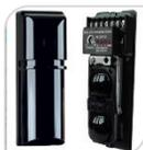
Barriera all'infrarosso – Portata 60m - Potenti lenti Fresnel ad alta concentrazione di raggio – 8 frequenze selezionabili – Regolazione lenti 180° in orizzontale, 20 in verticale – Anti abbagliamento – Anti interferenza – Resistente al falso allarme dato dall'acqua, dalla polvere, e dagli insetti – LED per la calibrazione – Tempo di risposta da 50 a 700 ms – Tempo d'allarme 1.5s – Uscita d'allarme NO e NA – 10.8-18V
