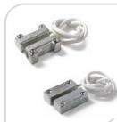
Contatto magnetico corazzato rettangolare in metallo per il montaggio a vista. Collegamento a 4 fili (2 del contatto, 2 fili per tamper antisabotaggio. IP65 In metallo - Confezione da 10PZ
