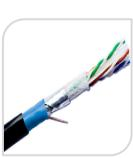
Matassa cavo rete FTP CAT6 4coppie x 0.5mm Solid COPPER 0.95mm PE con pellicola stagna, linea carico CCA da 0.4mm, treccia 6.4x0.2mm OD:6.4 ± 0,2mm PVC +PE
