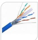
Matassa cavo rete SCHERMATO (multifilare)- 23 AWG 0.56mm **CCA** - adatto per l'inserimento nei plug CAT.6 - PER INTERNO – PVC
