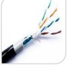
Matassa cavo rete FTP CAT5 4coppie x 0.52mm Solid COPPER 0.95mm PE con pellicola stagna, linea carico CCA da 0.4mm, treccia 6.4x0.2mm OD:6,2 ± 0,2mm PVC +PE.
