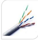
Matassa cavo rete UTP CAT5E 4coppie x 0.52mm Solid COPPER , OD:5.2 ± 0,2mm PV. RAME PURO 100%
