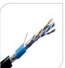
Matassa cavo di rete per esterno doppia schermatura SFTP CAT6, 4 coppie x 0.5mm Solid **CCA**, 0.95mm PE con pellicola stagna , linea carico CCA 0.4mm CCA , treccia 64x0.12mm OD: 6.4±0.2mm PVC+PE
