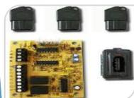
Chiave elettronica a triplo controllo resistivo ed uscita allarme per chiave falsa. Protetta contro il corto circuito, taglio cavi e tensioni indotte – Fornita con 1 inseritore Serie MAGIC nera e 3 chiavi codificate – Alimentazione 12V. Assorbimento 20mA
