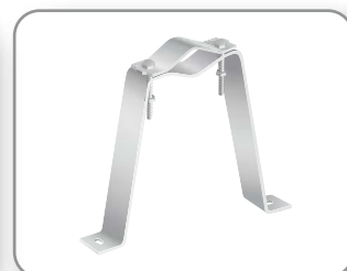
Zanca tipo "U" Rinforzata 174 - Mod. ZN1024 Lunghezza 20 cm Palo \phi 30-80 mm Viti M10x90 - 2 asole 15x10 mm
