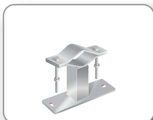
Zanca EMILIA Tubolare 210 - Mod. ZNL10Q Lunghezza 10 cm Palo \phi 25-60 mm Piastra 170x50x05 mm
