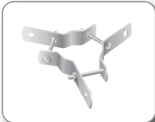
Ralla TRIS per Fune 172 - Mod. ZN1230 Viti M6x45 mm Palo \phi 25-45 mm Nastro 20x3 mm
