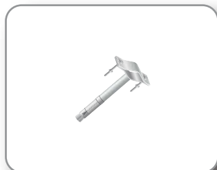
Zanca ESPANSIONE 10 cm 165 - Mod. ZN1013 Lunghezza 10 cm Palo \phi 25-45 mm Cavallotto 30x4 mm - Viti M6x45
