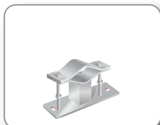
Zanca EMILIA Tubolare 210A - Mod. ZNL05Q Lunghezza 5 cm Palo \phi 25-60 mm Piastra 170x50x05 mm
