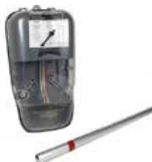
**CAMERA DI ANALISI DI FUMI PER CONDOTTE DI ASPIRAZIONE** - Camera di analisi fumi per condotte, permette di campionare l'aria di passaggio all'interno di una condotta d'aria. L'applicazione è esterna alla condotta e tramite un tubo di campionamento viene aspirata l'aria, filtrata e indirizzata su un rivelatore ottico di fumo (non in dotazione) all'interno della camera stessa.
