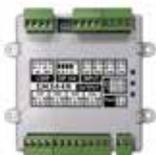
**MODULO 4 INGRESSI/USCITE ED INTERFACCIA ZONE CONVENZIONALI** - Il modulo mette a disposizione 4 ingressi supervisionati e 4 uscite relé. Due ingressi dei quattro possono essere configurati come zone convenzionali, alimentati dal LOOP o da una fonte di alimentazione locale. Le 4 uscite sono supervisionate per la gestione di segnalatori ottico-acustici.
