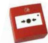
**PULSANTE ANTINCENDIO VIA RADIO** - Pulsante di allarme radio ripristinabile per mezzo di un'apposita chiavetta (fornita) e conforme alla norma EN54-11. Dotato di LED bicolore fornisce informazioni relative allo stato del dispositivo e della sua batteria.
